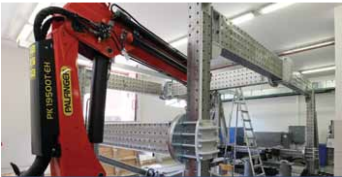
Новое оборудование лаборатории испытания крупноразмерных строительных конструкций
